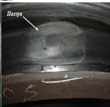
Рис. 1 – Примеры деформаций колесных пар а) выщербина; б) навар; в) ползун.
